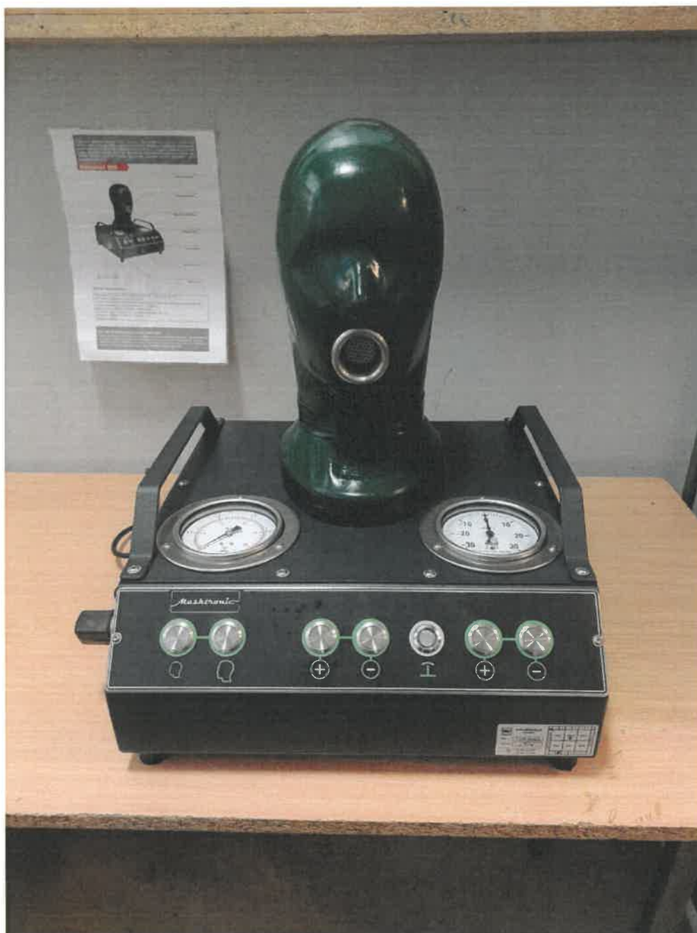
Zdjęcie 5. Moduł urządzenia testowego do manualnego przeprowadzania badań statycznych masek naciśnieniowych - Masktronic Compact 200.
